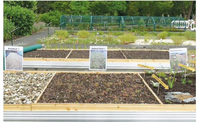
Blick auf die frisch angelegten Demonstrationsdächer.
